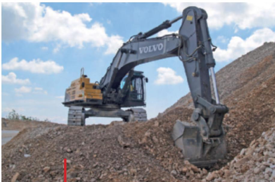
**L'EC700C è equipaggiato con un motore Volvo a 6 cilindri, raffreddato ad acqua, sviluppato specificamente per escavatori a bassa emissione di scarico e alta efficienza nei consumi e capace di erogare una potenza netta di 316 kW a 1.800 giri/min.**
