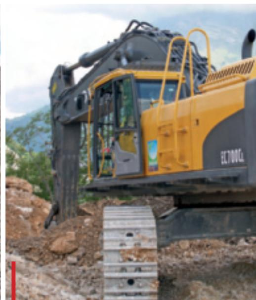
**Il sottocarro dell'EC700C è a «X» con cingoli ingrassati e sigillati di serie: ogni carro è alimentato da un motore di traslazione con cambio a due velocità, mentre i freni sono multidisco.**
